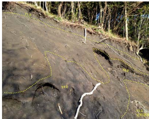
写真5 崩壊面の例。Y1.0火山灰とその上位のレス(厚さ数十cm~1m程度)が薄くはがれ落ちている。やや深くえぐられた部分に、さらに下位の層が露出。露頭下部にあるねじり鎌の長さは25cm。図2の地点03
