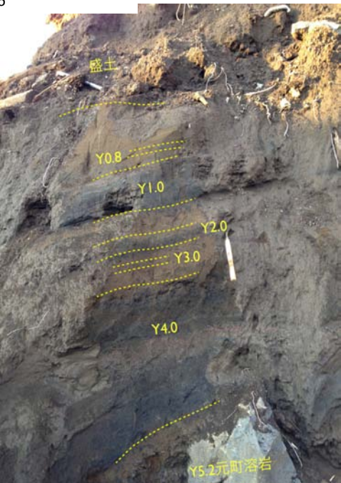
写真8 神達地区の地質断面。露頭上のねじり鎌の長さは25cm、図2の地点06
