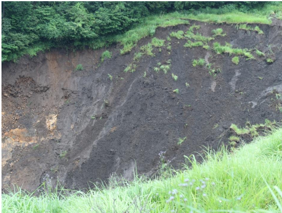
図2C 図2Bの右側部分の拡大。黒色部も固結度の低そうな砂礫である。
